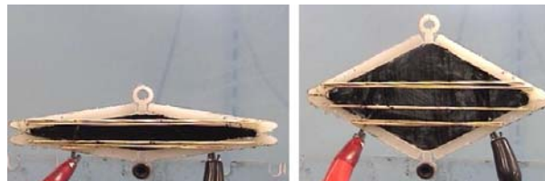
Fig. 4. The MIT experimental diamond Dielectric Elastomer Actuator [8], [9].
