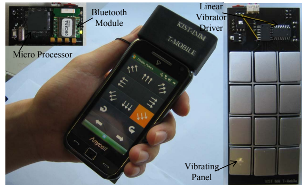
Fig. 1. Vibrotactile pad device, the T-Mobile
