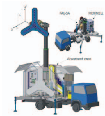
Fig 2 Mobile unit to locate PAU-SA and MERITXELL instruments.
